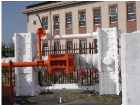
Trillingsbestendig montageapparaat voor isolatoren en bliksemafleider
